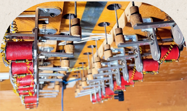
Mit dem Ersatz der Wippmagnete durch Ventilscheibenmagnete werden klappernde, störende Geräusche eliminiert.
